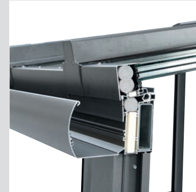
Design-Rinne mit speziellen Dämmkernen in der Isolierzzone und regendichte Einfassung großer Elementbautiefen (bis 95 mm)
